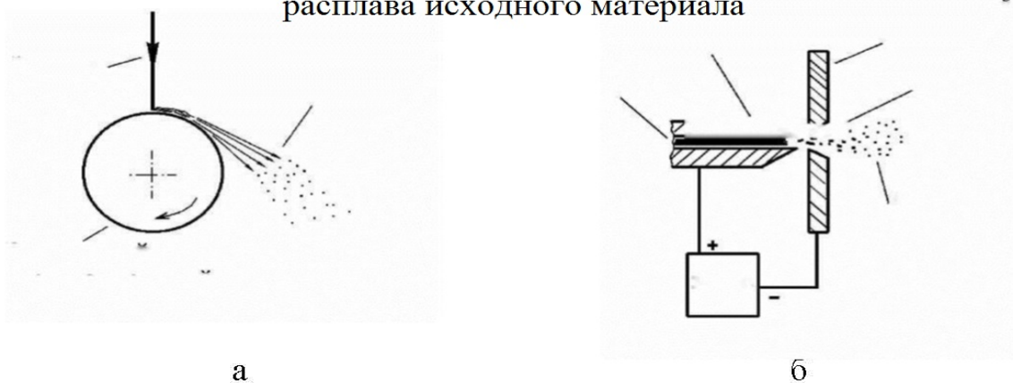
Рис. 4. Принципиальная схема распыления порошка из расплава при помощи водоохлаждаемого барабана (а) и электродинамического распыления (б).
