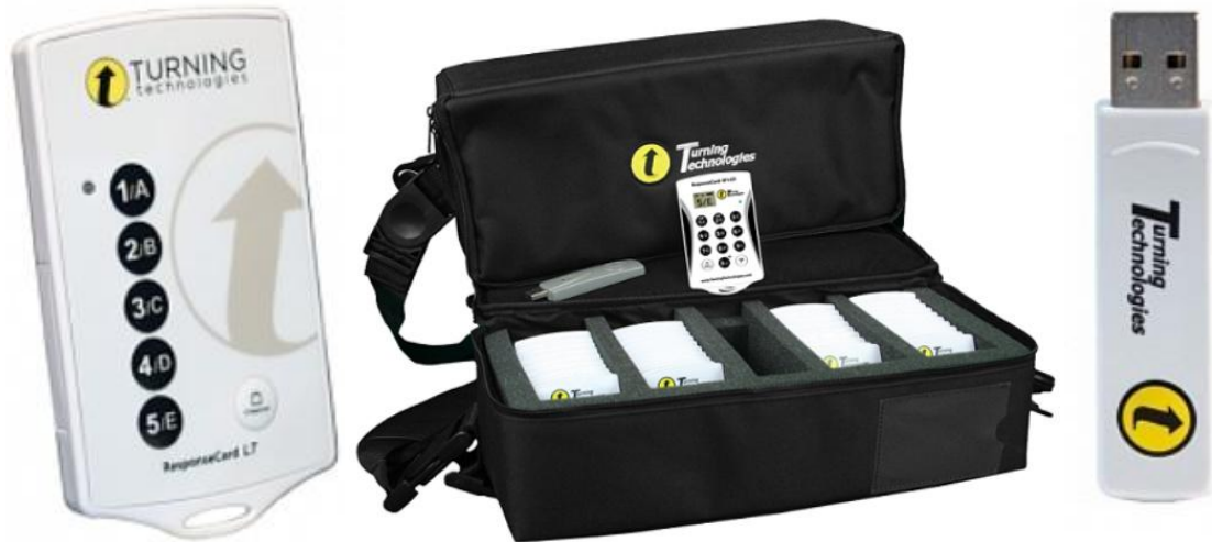
Рис. 1. Пример пульта учащегося, коробки для хранения пультов и приемника сигналов пультов, который подключается к USB-порту компьютера [1]
