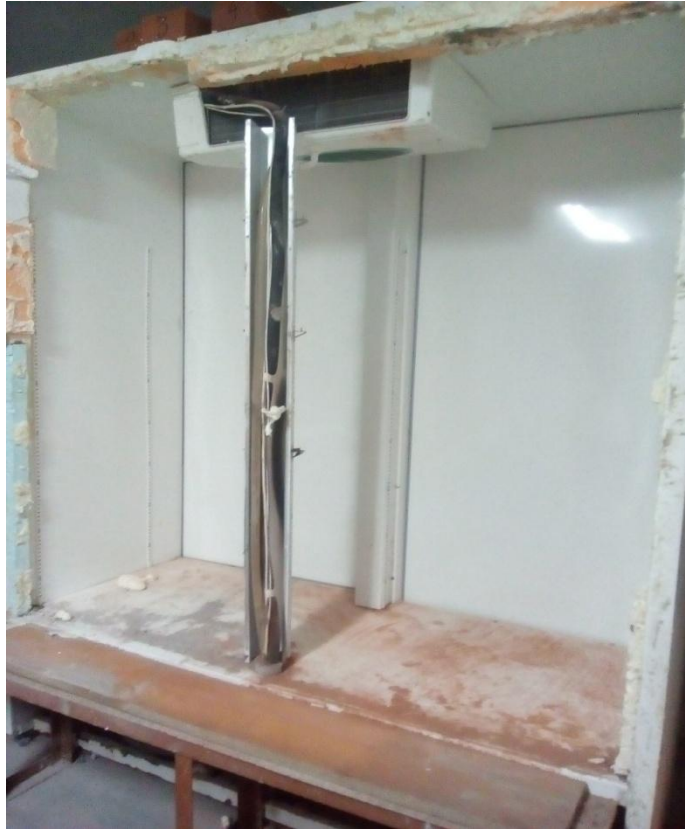
Рис. 6. Климатическая камера на базе холодильника для натуральных испытаний фрагмента ограждающей конструкции
