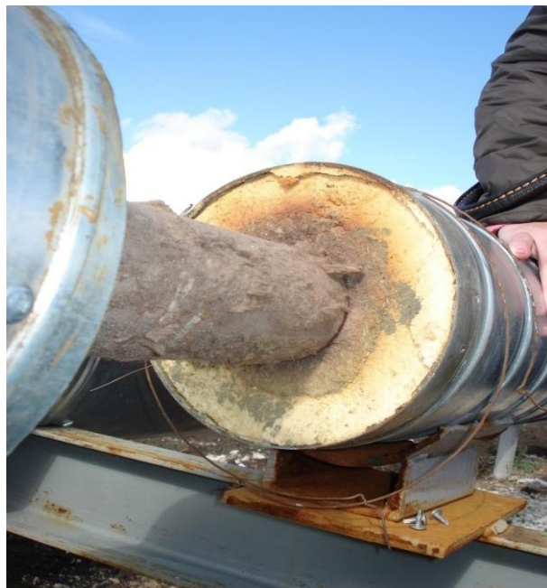
Рис. 2. Торец двухслойной тепловой изоляции (базальт + пенополиуретан)
