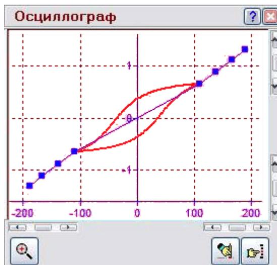
Рис. 7.6. Получение основной кривой поляризации
