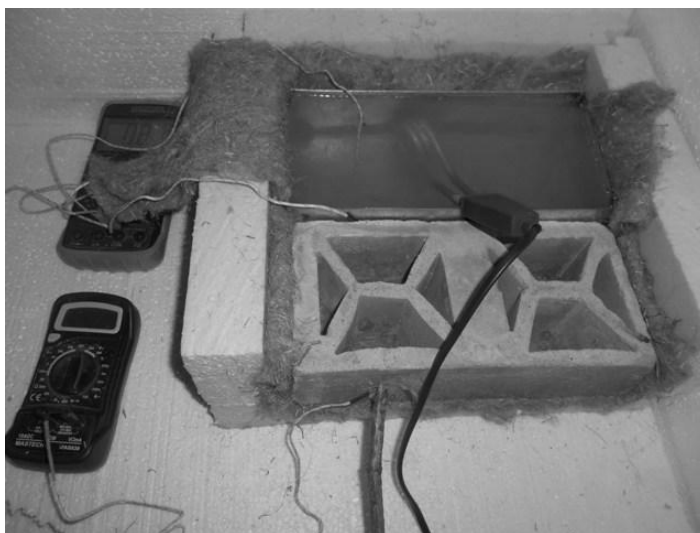
Рис. 2. Лабораторная установка для тепловых испытаний
