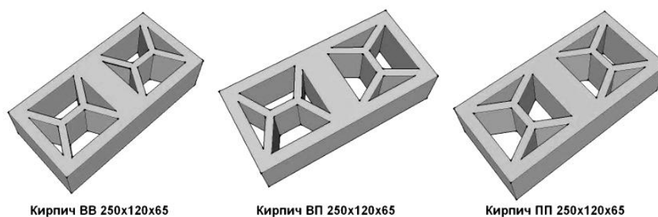
Рис. 1. Три вида кирпичей с перегородками Штейнера
