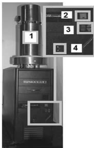
Рисунок 5. Фронтальный вид прибора: 1 – нагревательный элемент; 2 – кнопка питания с индикатором питания; 3 – тумблер перемещения нагревательного элемента; 4 – индикатор обрыва регулирующей термопары
