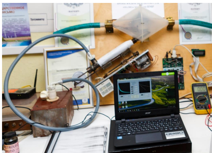
Рис. 3. Учебный стенд по изучению системы прободоотбора и анализа ПМРА
