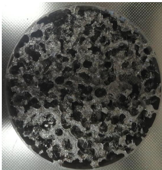
Рис. 2. Часть экспериментального образца, представляющего собой трубку со вставкой высокопористого ячеистого материала, созданная посредством 3d печати
