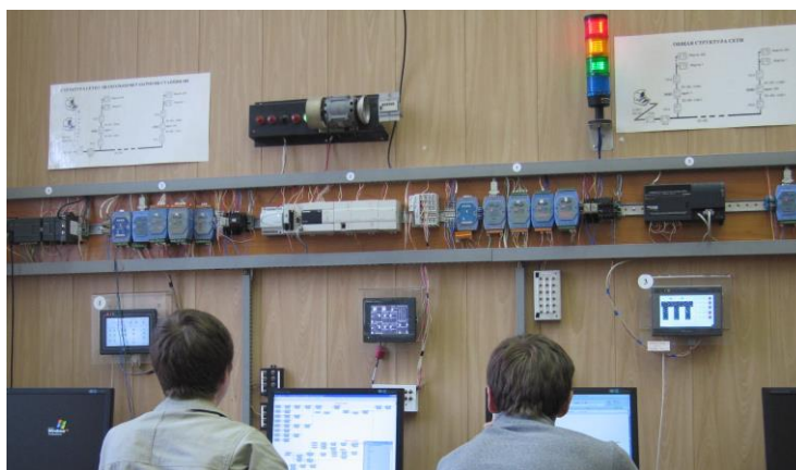
Рис. 1. Размещение ПЛК и модулей I-7000 в лаборатории
