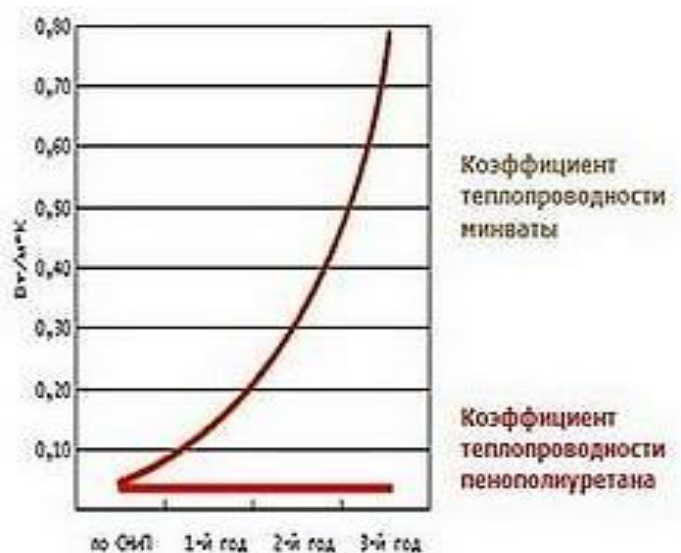
Рис. 4. Сравнительные коэффициенты теплопроводности минваты и пенополиуретана
