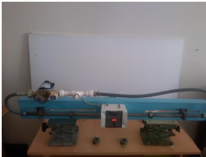
Рис. 3. Общий вид действующего макета вибрационно-амплитудного датчика плотности суспензий
