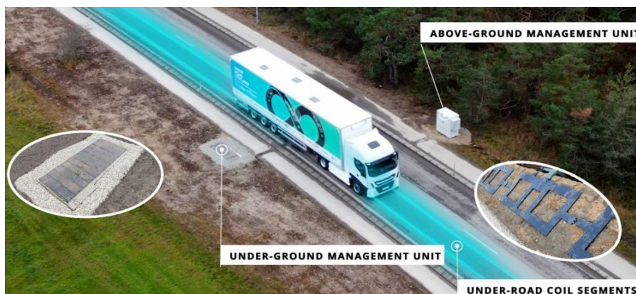
Рис.3. Беспроводная зарядка грузовика в Швеции
