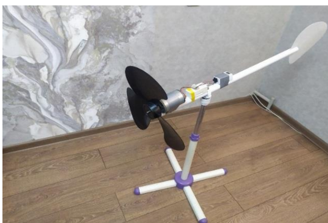
Рис. 2. Внешний вид экспериментальной ветроустановки
