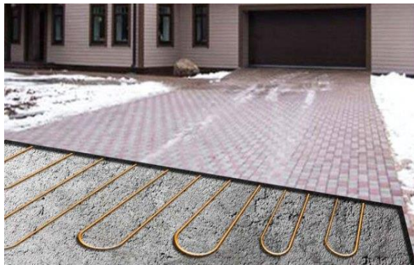
Внешний и внутренний вид устройства системы обогрева тротуаров
