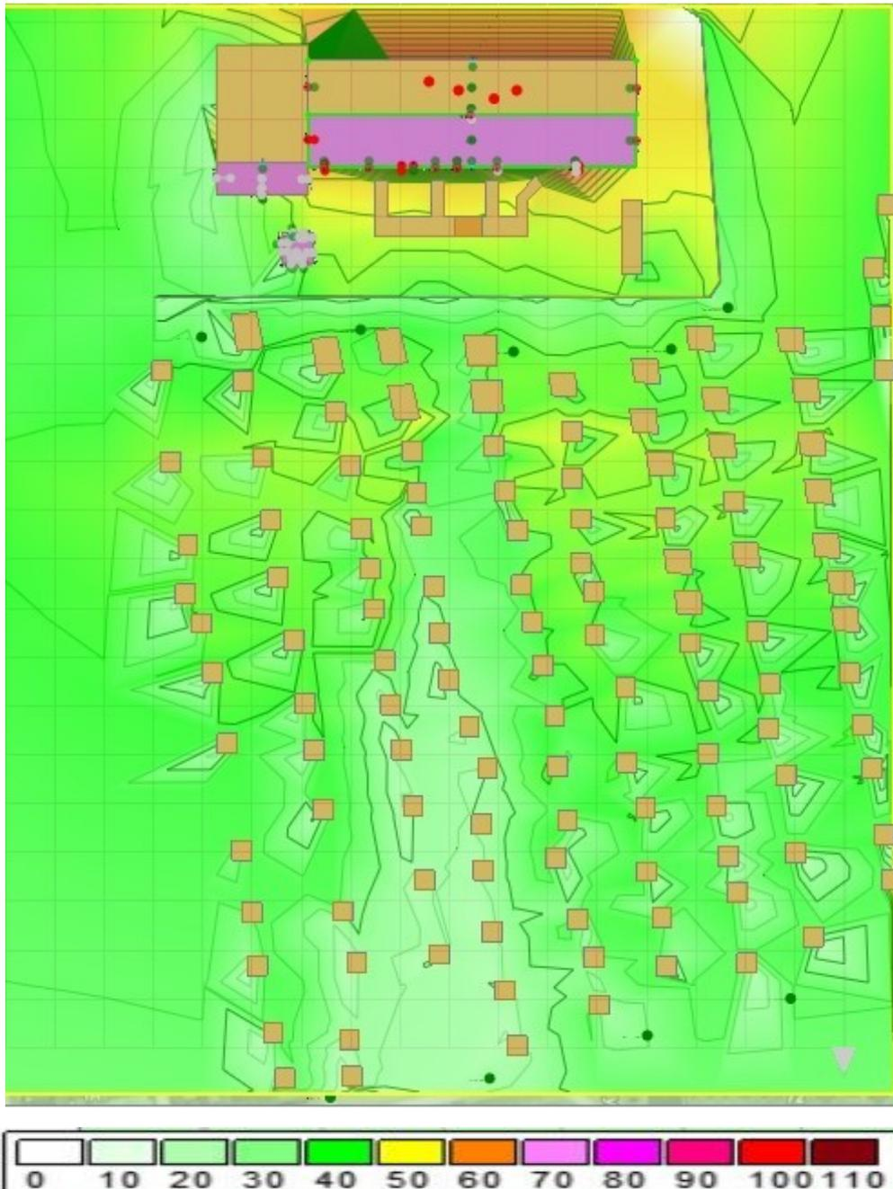
Рисунок 3.20 - Шумовая карта при исключении источника шума – наружной газовой трубы
