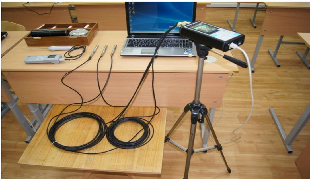
Рисунок 2.1 - Измерительный комплекс «Экофизика» 110А [30]
