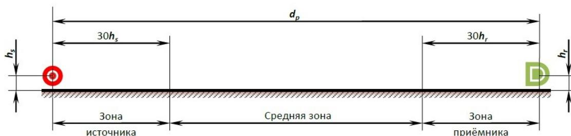
Рисунок 3.3 – Зоны при определении затухания из-за влияния земли [132]
