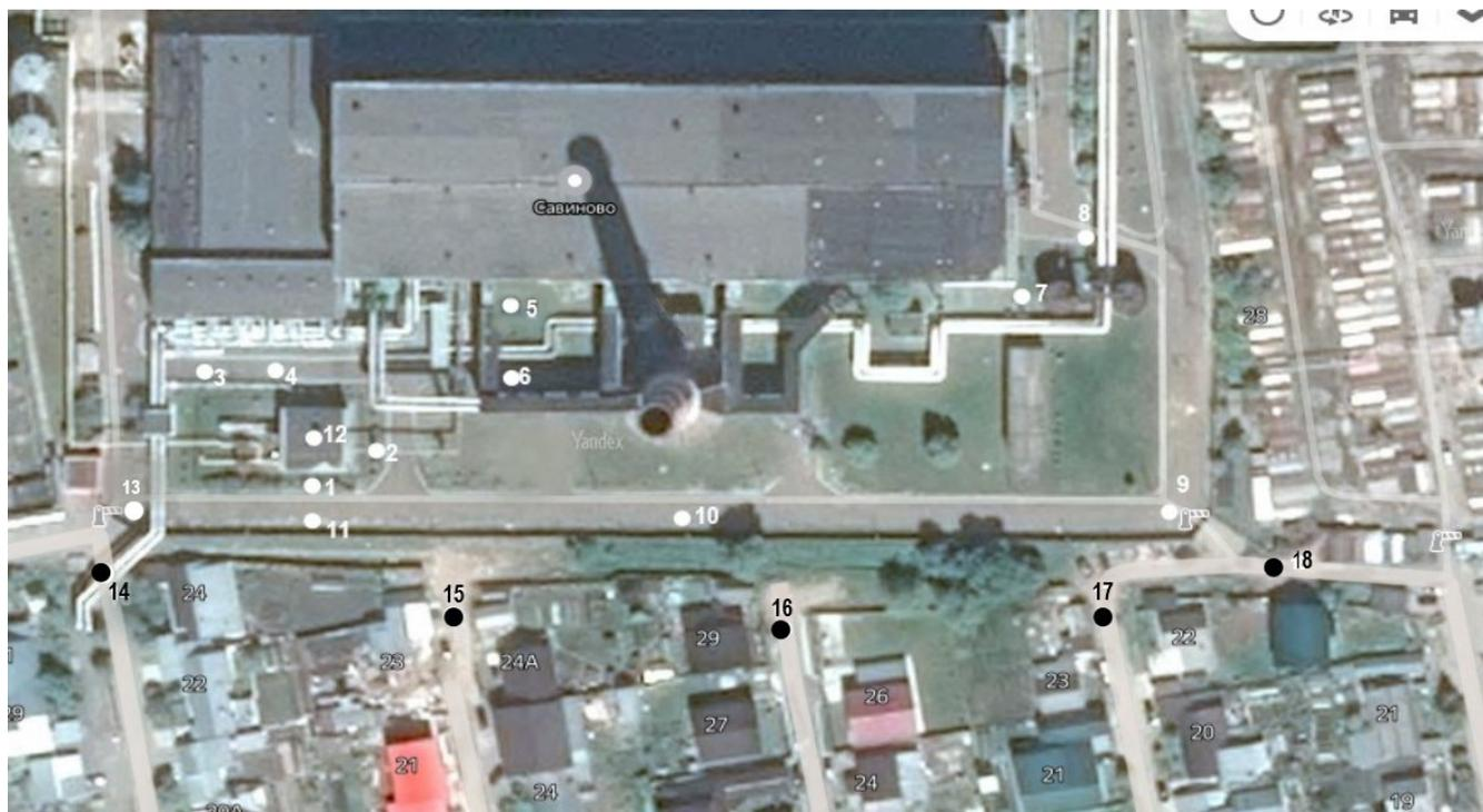
Рисунок 4.8 – Точки измерения уровня звука после внедрения шумозащитных мероприятий
