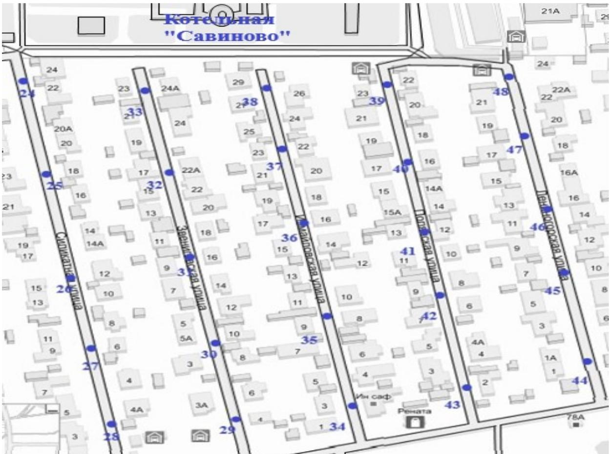
Рисунок 2.44 – Расположение точек установки микрофона в жилом массиве
