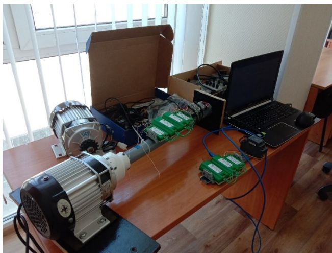
Рисунок 10. Стенд для измерения вращающего момента и частоты вращения
