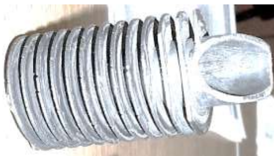
Рисунок 4.6 – Трубчатые теплообменные поверхности АВО газа
