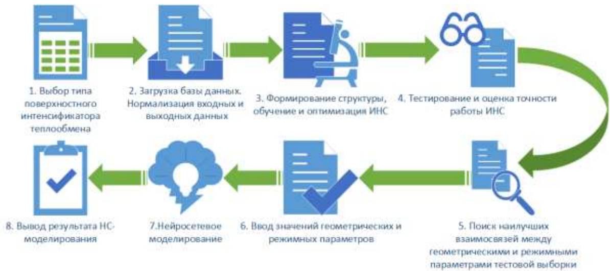
Рисунок 3.1 – Этапы функционирования прикладного программного обеспечения, реализующего исследование тепловой, гидравлической и теплогидравлической эффективности в широком диапазоне свойств теплоносителей, режимных и геометрических параметров поверхностных интенсификаторов теплообмена
