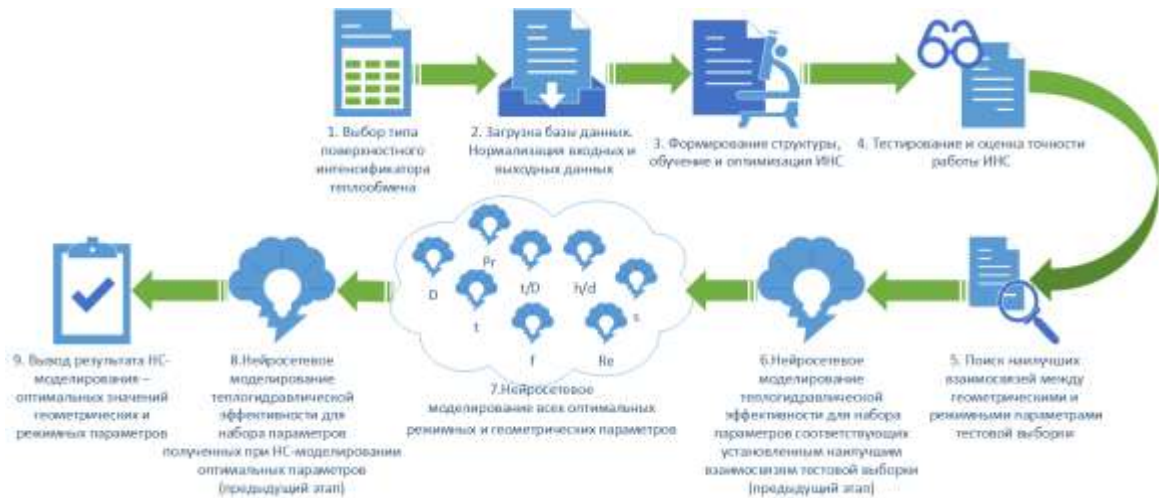
Рисунок 3.11 – Этапы функционирования прикладного программного обеспечения нейросетевого моделирования оптимальных режимных и геометрических характеристик при поверхностной интенсификации теплообмена
