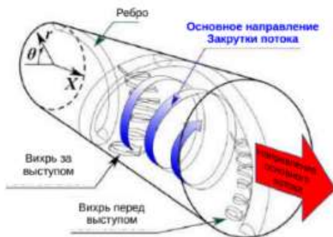
Рисунок 1.21 – Схематическое изображение структуры течения в канале с внутренним спиральным оребрением [90]
