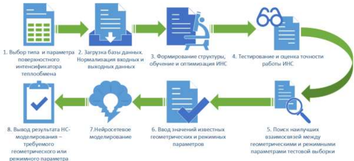
Рисунок 3.9 – Этапы функционирования прикладного программного обеспечения нейросетевого моделирования режимных и геометрических параметров поверхностных интенсификаторов теплообмена
