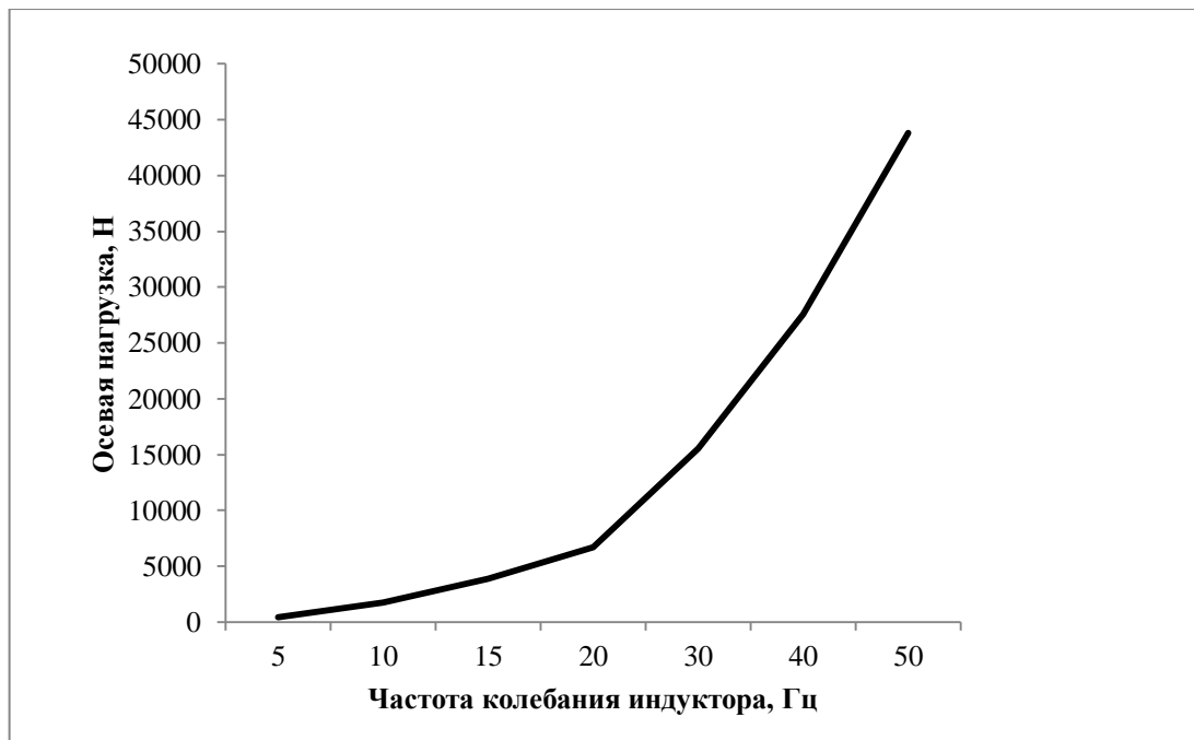
Рисунок 3.5 – Рассчитанная теоретическая зависимость осевой нагрузки на индуктор от частоты его колебаний
