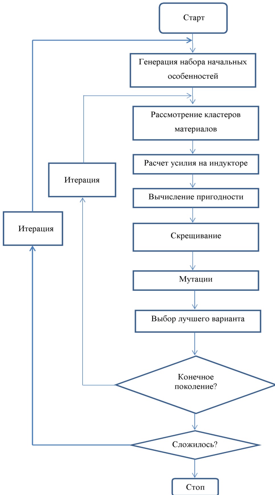
Рисунок 3.16 – Блок-схема генетического алгоритма для топологической оптимизации индуктора
