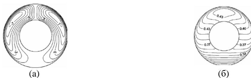
Рис. 1.1. Линии тока (а) и изотермы (б) конвективного движения в цилиндрическом слое с теплоизолированной внутренней поверхностью для радиуса R = 0.5 , cF = 0.55 , Gr = 10\,000 , Pr = 1 , Da = 10-4 , Bi = 1
