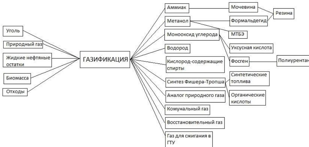
Рисунок 1.1. Применение процесса газификации в производстве различных продуктов
